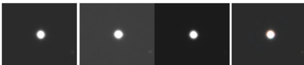
StarTest dell'AIRY APO104T con immagine intrafocale (a sinistra) ed extrafocale (a destra).
